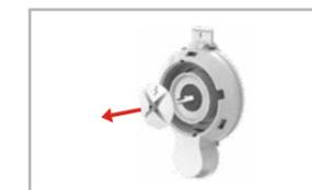
Den Instantmixer demontieren und reinigen. Siehe „Demontage Instantmixer“! Sicherstellen, dass der Instantmixer nach erfolgter Reinigung korrekt eingesetzt wurde.
