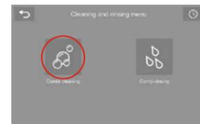
Als er dan op de toets voor COMBI-REINIGING wordt gedrukt, wordt het reinigingsproces gestart.
