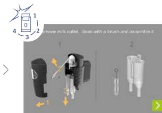
Die Teile ausbauen wie auf dem Display dargestellt, nach dem Hygienekonzept reinigen und wieder montieren. Befolgen Sie die detaillierte Anleitung „Demontage Milchauslauf / Kaffeeauslauf“ auf der Rückseite.
