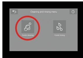
Durch Drücken der KOMBI-REINIGUNGS-Taste wird die Reinigung gestartet.
