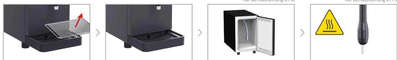
Tropfgitter von der Restwasserschale entnehmen und reinigen.
